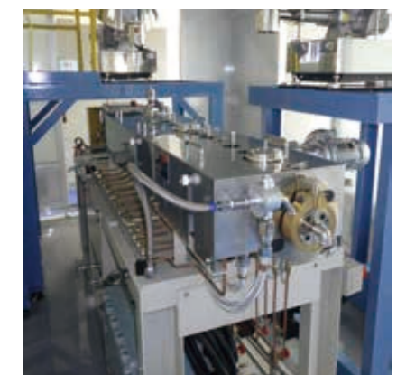
高粘度流体の混合や除熱に優れる二軸押出機
